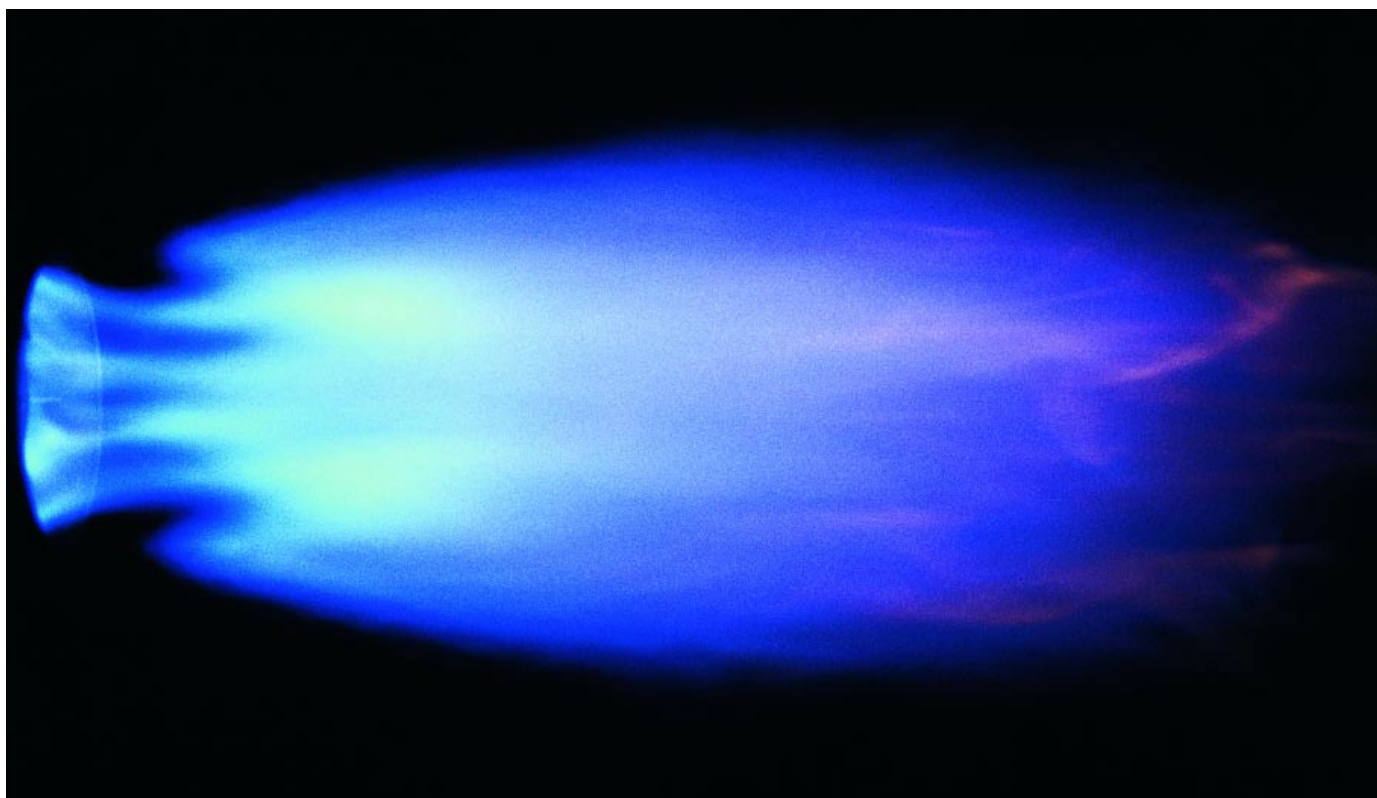
Typisk flambild på gasbrännare i utförande LN (LågNO x )
